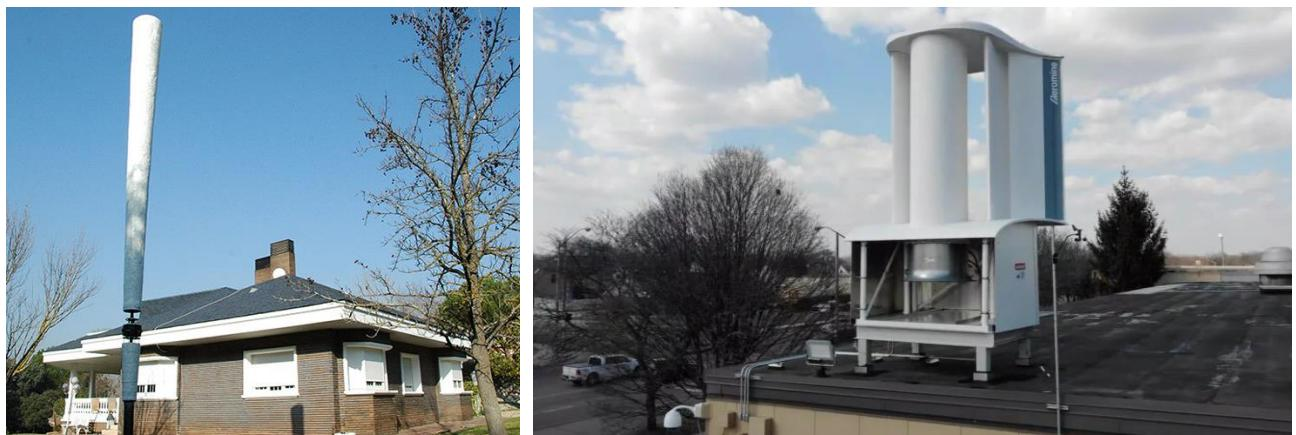
Obrázek 46: Inovativní bezlopatková VtE.Vortex Bladeless (vlevo) a VtE Aeromine Technologies (vpravo).
